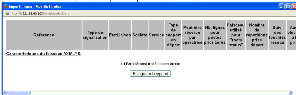
La configuration du faisceau SIP Axialys est à présent partiellement renseignée; il convient de la compléter avec les paramètres spécifiques du client.
